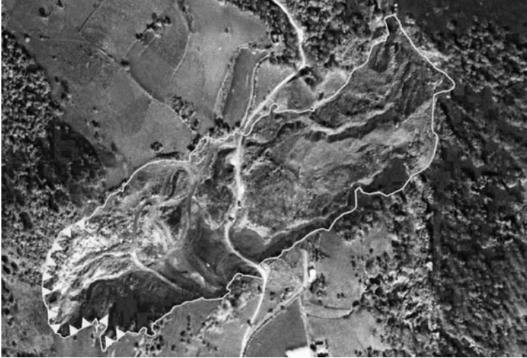
Figura 4. Imagen de satélite del deslizamiento de San José Chagchaltzin, Sierra Norte de Puebla. La línea blanca establece el límite del desplazamiento del material.
