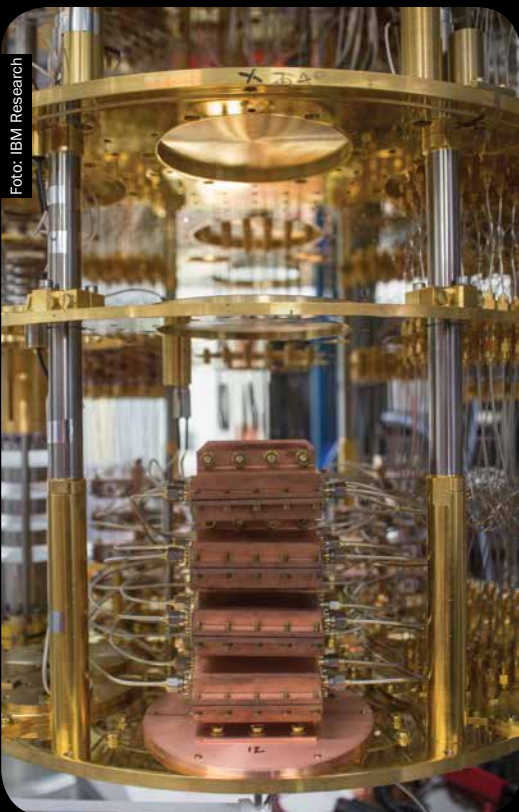
Sistema de enfriamiento de la computadora cuántica de IBM.
